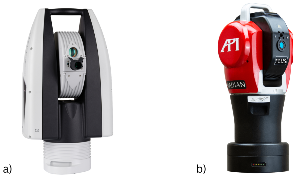
Rysunek 2.14: Trackery laserowe a) Leica AT960 (źródło: materiały promocyjne Hexagon) b) API Radian Plus (źródło: materiały reklamowe API).
