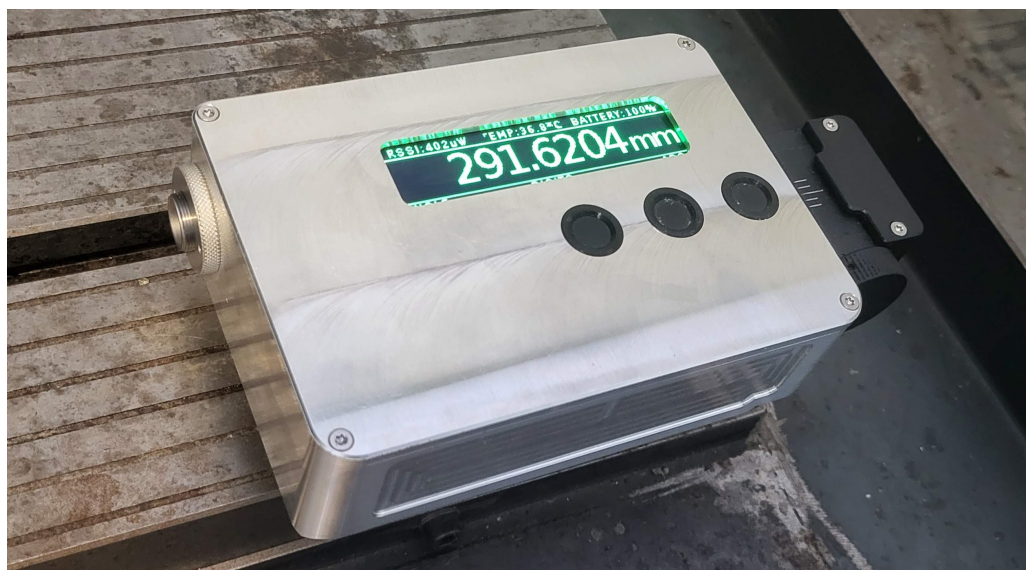
Rysunek 4.27: Prototyp dalmierza w trakcie pomiarów na stole frezarki CNC.
