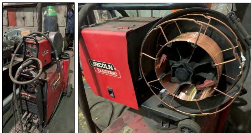
Rys. 4.5. Stanowisko napawania FCAW Lincoln Electric POWERTEC 505S
