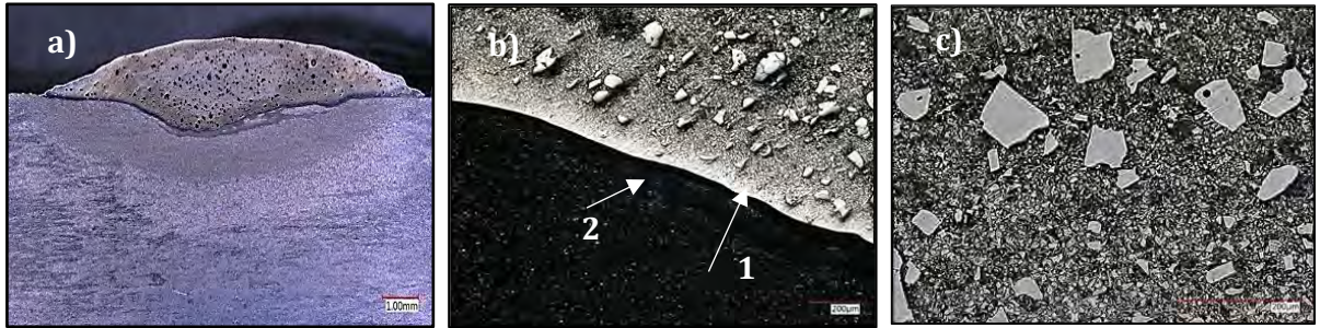
Rys. 4.14. Próbką F/SK900/1D2 (a) makrostruktura napoiny (traw. Adler, pow. 30x), (b) mikrostruktura obszaru przy linii wtopienia napoiny pow. 200x (1 – warstwa nawęglona, 2 – warstwa odwęglona), (c) mikrostruktura obszaru napoiny (SEM, pow. 500 x)
