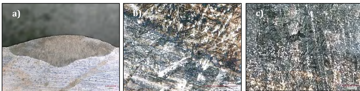
Rys. 4.20. Próbką P/SK600/1I1: (a) makrostruktura napoiny (traw. Adler, pow. 30x) (b) mikrostruktura obszaru przy linii wtopienia napoiny (pow. 200x), (c) mikrostruktura obszaru napoiny (SEM (a) pow. 500x
