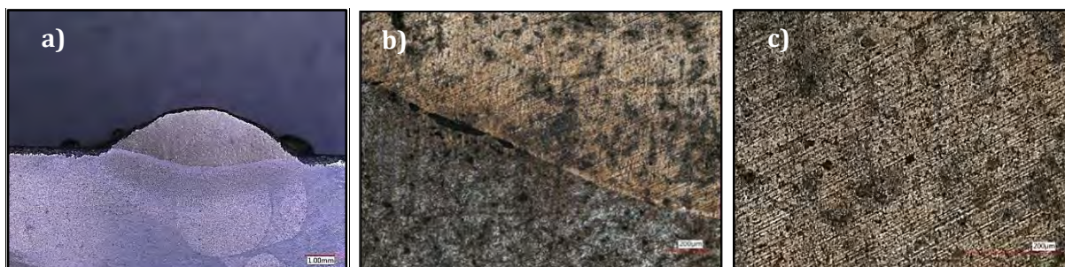
Rys. 4.13. Próbka F/SK600/1C2: (a) makrostruktura napoiny (traw. Adler, pow. 30x), (b) mikrostruktura obszaru przy linii wtopienia napoiny (pow. 200x), (c) mikrostruktura obszaru napoiny (SEM, pow. 500x)
