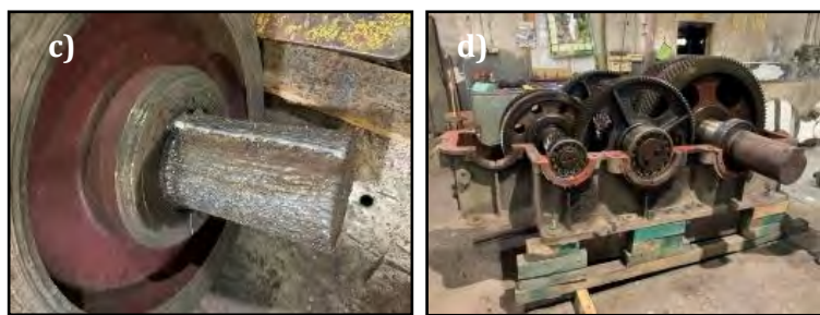
Rys. 1.1. Przykłady regeneracji części maszyn i urządzeń w Hucie Miedzi Legnica narażonych na zużycie ścierne i korozyjne, (a) rynny zsypanowe, zsypy, sita, (b) czopy wałów, gniazd, rolek prowadzących, (c) rolki biegowo, (d) koła zębate
