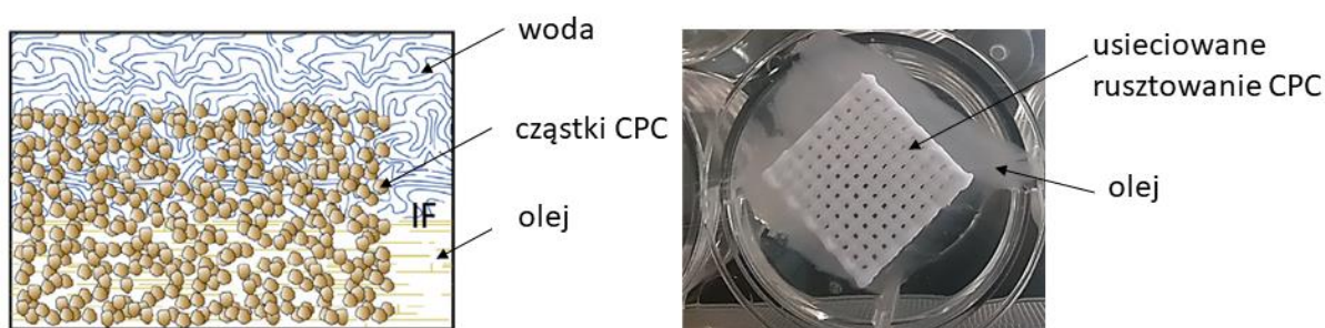
Rysunek 12. Schemat wiązania cementu CPC [77] oraz przykład usieciowanego rusztowania CPC po 3 dniach inkubacji w atmosferze wodnej i temperaturze 37\text{ }^{\circ}\text{C} ; widoczna faza olejowa, która wypłynęła na zewnątrz rusztowania.
