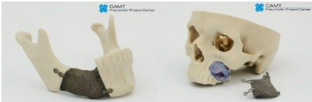
Rys. 30. Przykłady wykonanych personalizowanych implantów ze stopu Ti-6Al-7Nb wypełnionych BSF.
