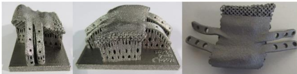
Rys. 5. Widok na: a) wytworzony implant na platformie roboczej (po lewej i na środku), b) implant po procesie HIP i modyfikacji powierzchni z wykorzystaniem obróbki strumieniowo-ściernej (po prawej).
