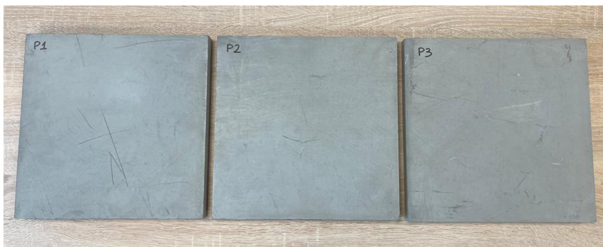
Rys. 4.3 – 3 z 12 płyt betonowych o wymiarach 300mm x 300 mm x 3 mm, przeznaczonych do badania
