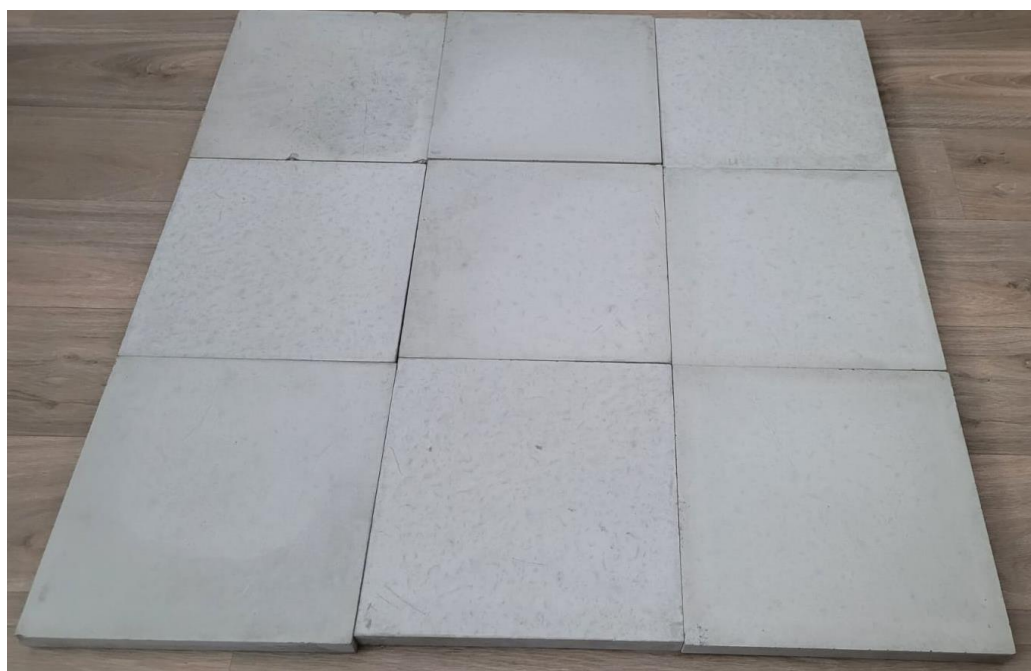
Rys. 4.4 - 9 z 12 płyt betonowych o wymiarach 300mm x 300 mm x 3 mm, przeznaczonych do badania
