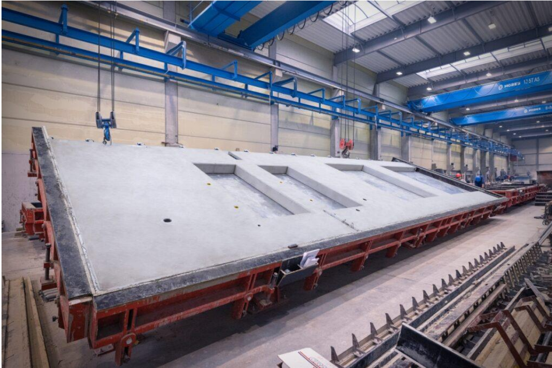
Rys. 1.12 – Zdjęcie uformowanej ściany prefabrykowanej w zakładzie Betard [130]
