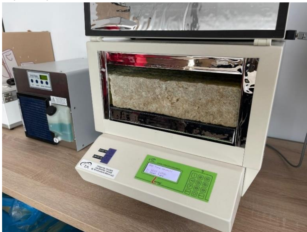
Rys. 4.2 – Aparat płytowy z osłoniętą płytą grzejącą
