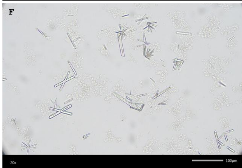
Rysunek 40. Rozkłady wielkości cząstek struwitu (A-C) oraz mikroskopowy obraz kryształów (D-F) otrzymane w testach: A i D - MAP2, B i E - MAP3 oraz C i F - MAP4
