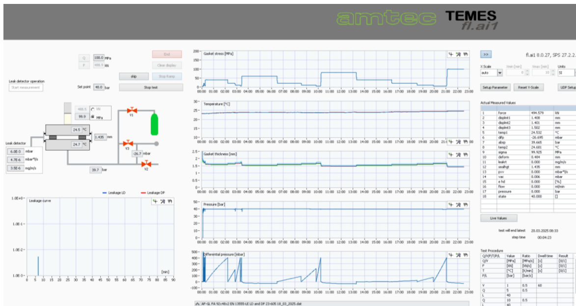
Rys. 4.9. Przykładowy interfejs programu TEMES fl.ai1 V8.1 w trakcie badania szczelności.
