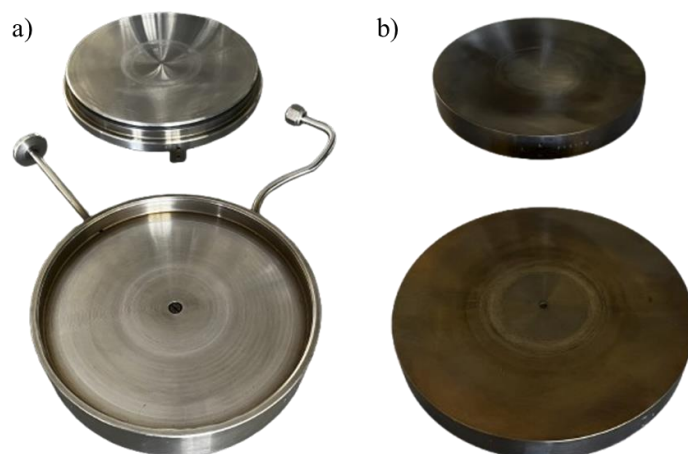
Rys. 4.6. Fotografia płyt dociskowych dedykowanych do badań: a) szczelności, b) mechanicznych.
