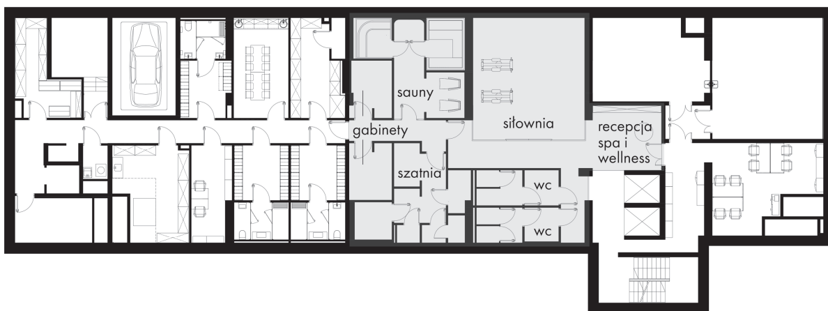
Rys. 36. Schemat planu poziomemu -1 hotelu Puro w Warszawie – program podstawowy strefy spa i wellness [oprac. własne]
