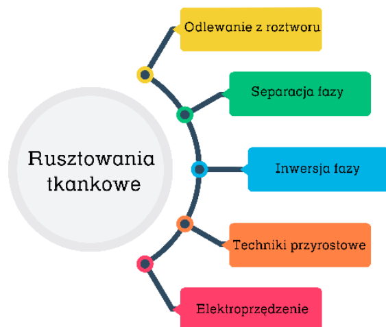
Rysunek 26. Najczęściej spotykane metody wytwarzania rusztowań tkankowych
