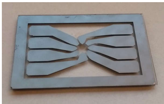
Rys. 73. Wykonany, krzemowo-szklany oktopol.
