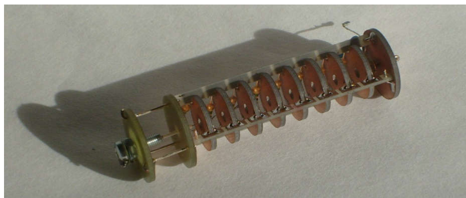
Rys. 100. Spektrometr ruchliwości jonów wykonany z laminatu szklano-epoksydowego.
