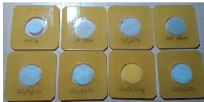
Rys. 119. Wykonane scyntylatory z 8 rodzajów luminoforów.
