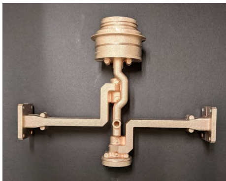
Rys. 26. Klistron wydrukowany przez spiekanie proszku stali nierdzewnej, miedziany po wydruku [40].
