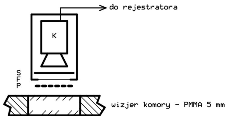
Rys. 138. Modyfikacja układu pomiarowego, pozwalająca na wykonywanie zdjęć rentgenowskich kamerą przemysłową. K – kamera, S – scyntylator J6679, F – folia aluminiowa zapewniająca światłoszczelność obudowy, P – próbka.
