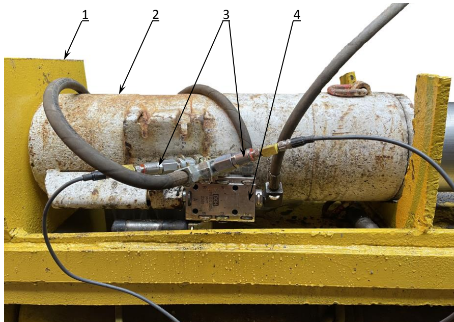
Rys. 6.9. Widok stanowiska badawczego przygotowanego na potrzeby weryfikacji modelu matematycznego, gdzie: 1 – rama stanowiska, 2 – stojak hydrauliczny, 3 – czujniki ciśnienia, 4 – blok zaworowy
