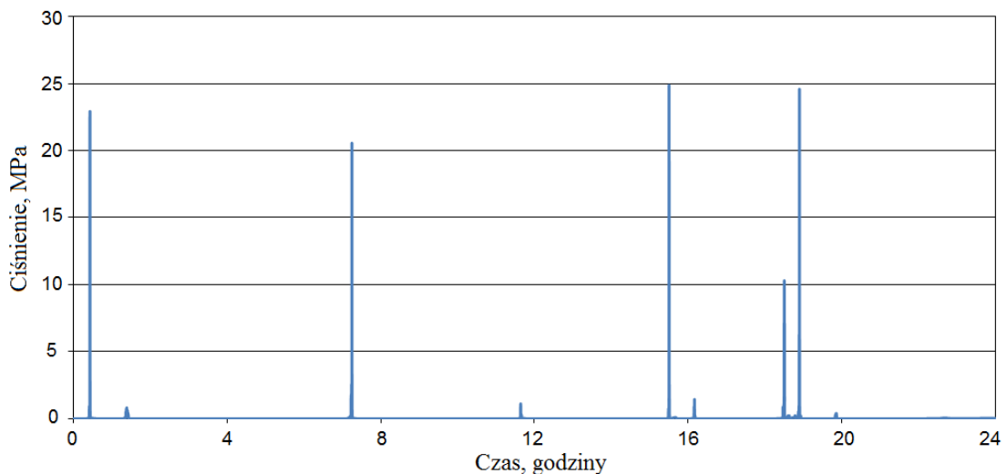
Rys. 9.24. Przebieg ciśnienia w przestrzeni podtłokowej stojaka z nieszczelnością zewnętrzną
