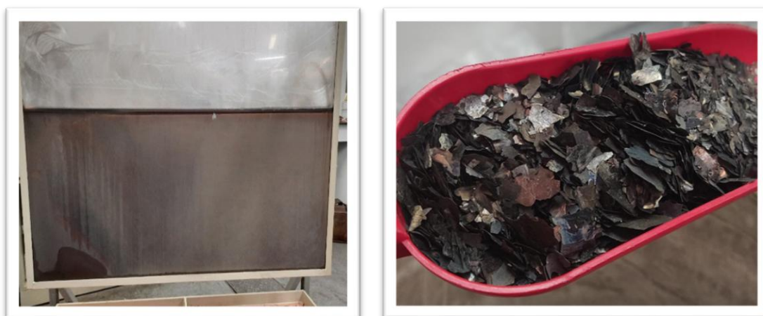
Rysunek 10. Osad katodowy kobaltu (po lewej) oraz produkt kobaltowy po usunięciu z elektrody stalowej (po prawej) [35]
