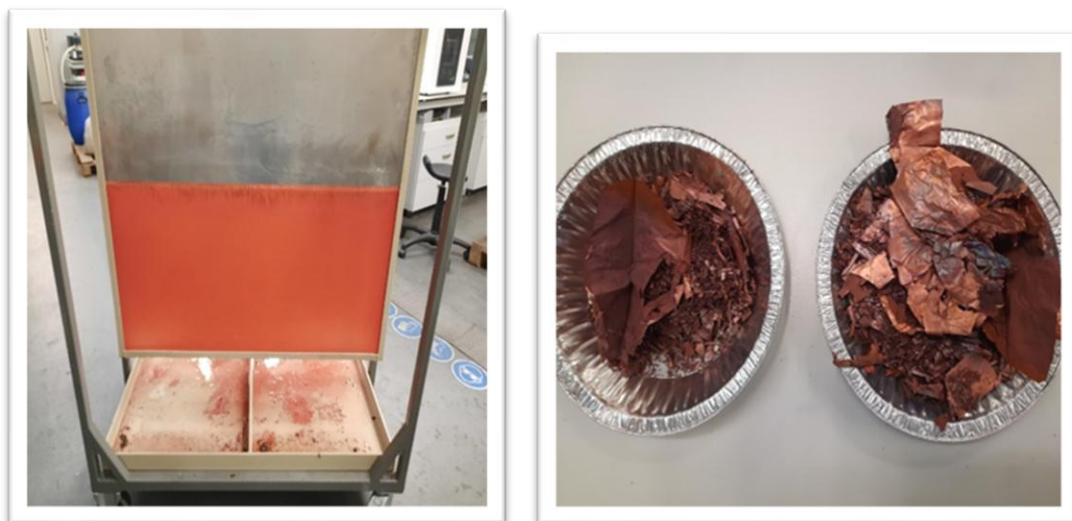
Rysunek 9. Osad katodowy miedzi (po lewej) oraz folia miedziana po usunięciu z elektrody stalowej (po prawej) [34]
