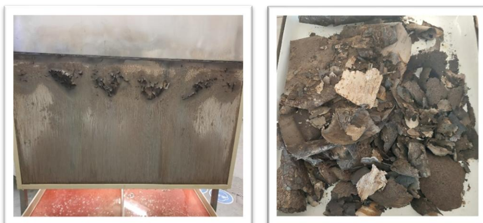
Rysunek 11. Osad katodowy niklu (po lewej) oraz produkt niklowy po usunięciu z elektrody stalowej (po prawej) [35]
