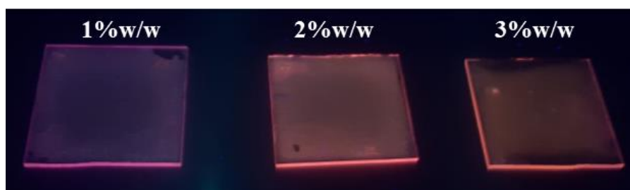
Rysunek 6.2.1. Zdjęcie cienkich warstw C1:PMMA o stężeniu wagowym wynoszącym kolejno: 1%, 2%, 3% pod lampą UV.
