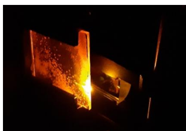
Rysunek 8.1.8. Zdjęcie emisji z cienkiej warstwy \alpha -CD:C1 wykonane z wykorzystaniem filtra w celu wycięcia wiązki zbudzającej.
