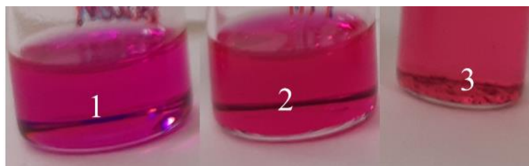
Rysunek 6.4.5. Zdjęcie roztworów barwnika C3 w rozpuszczalnikach o wzrastające wartości polarności: 1-toluen,2- THF,3- cykloheksanon, 4-DMF, 5-woda.
