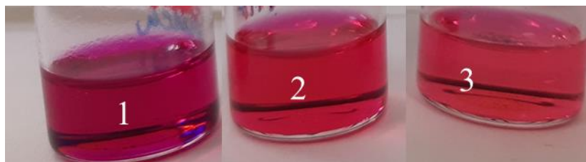
Rysunek 6.4.1. Zdjęcie roztworów barwnika C1 w rozpuszczalnikach o wzrastające wartości polarności: 1-toluen, 2- THF, 3-woda
