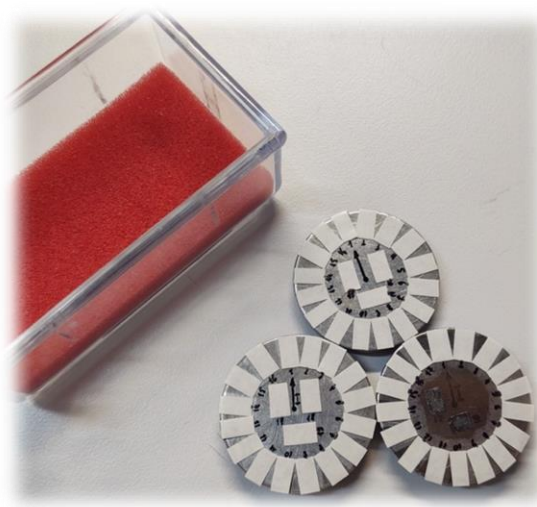
Rysunek 43 Przygotowanie próbek do analizy SEM – rozmieszczenie na stolikach
