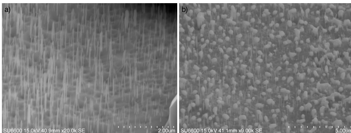
Rysunek 3.31. Powierzchnia maski z rutenu po selektywnej epitaksji azotku galu ( p = 500 hPa, T = 1045 °C, \frac{n_V}{n_{III}} = 1000 \frac{\text{mol}}{\text{mol}} ) (obraz SEM) [prace własne]: (a) nanodruły GaN wyrosłe na powierzchni maski; (b) koalescencja materiału epitaksjalnego osadzonego na górnej powierzchni nanodrutów GaN
