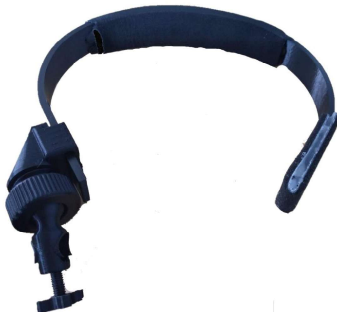
Rys. 3 Prototyp układu do pomiarów videootoskopowych. Zaprojektowane elementy obejmowały opaskę z możliwością regulacji długości oraz obejmę z przegubem kulistym w celu dopasowania kąta obserwacji otoskopowej. Materiały własne.
