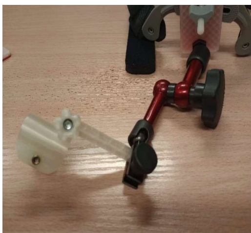
Rys. 1 Zaprojektowane elementy mocujące: prostokątna płytki pasująca do stelażu używanego do przezczaszkowej ultrasonografii Dopplerowskiej oraz obejmę otoskopu z przegubem.
