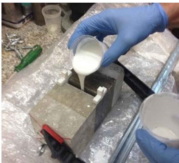
Rys. 4.8. Widok wypełniania żywicami uszczelniającym szczeliny w modelu przerwy dylatacyjnej.
