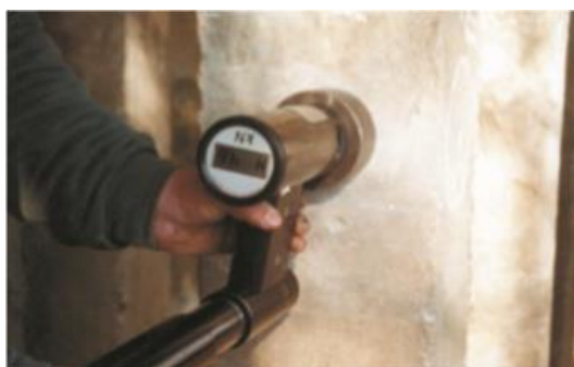
Rys. 3.12. Widok urządzenia pomiarowego do badania wytrzymałości na odrywanie „pull-off” [97].
