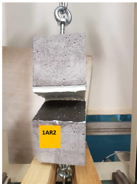
Rys. 6.12. Oderwanie się żywicy od powierzchni betonu przy próbie rozciągania modelu przerwy dylatacyjnej – utrata zbieżności zagadnienia modelowego MES – utrata niezawodności w uszczelnieniu przerwy dylatacyjnej.
