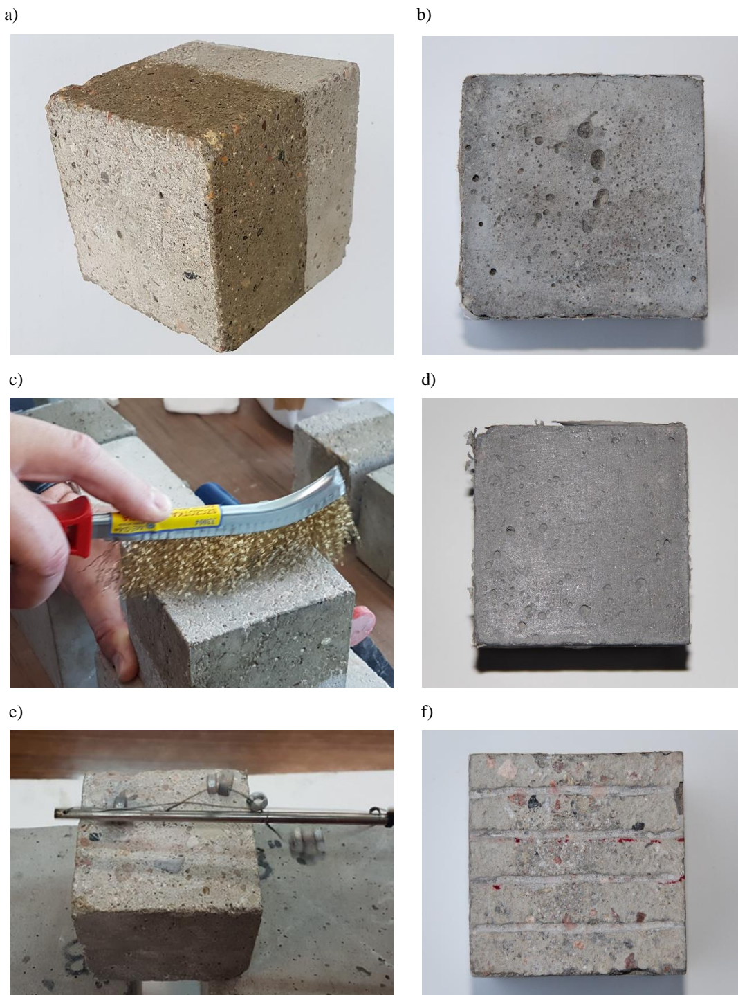
Rys. 4.3. Sposoby przygotowania podłoża betonowego próbek modelu przerwy dylatacyjnej: a) próbka betonowa, b) powierzchnia betonu nieczyszczona (B), c) etap czyszczenia ręcznego powierzchni betonu, d) powierzchnia betonu oczyszczona ręcznie (R), e) etap czyszczenia mechanicznego powierzchni betonu, f) powierzchnia betonu oczyszczona mechanicznie (M).
