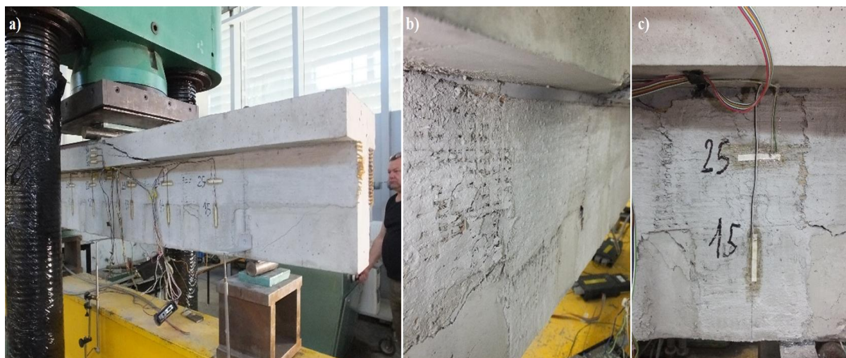
Rys. 4.36. Zniszczenie belek B_W: a) zarysowanie za podporą, b) zarysowanie zewnętrznej zaprawy świadczące o poślizgu włókien na zaprawie, c) pionowe zarysowanie w miejscu strzemion PBO
