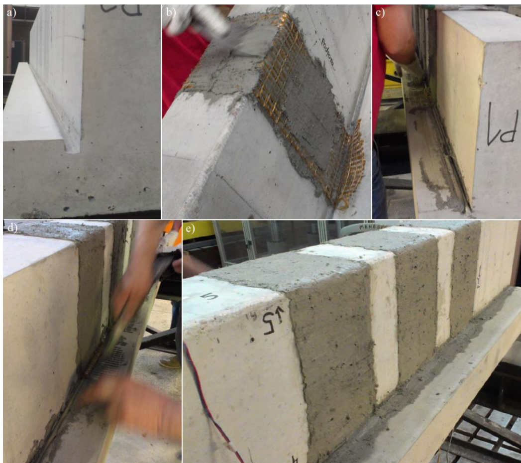
Rys. 4.9. Etapy przygotowania wzmocnienia z zakotwieniem prętowym
