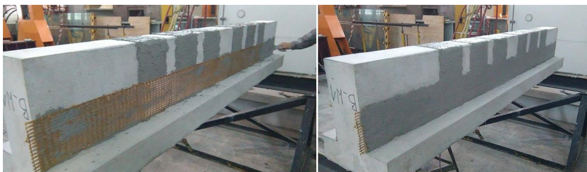
Rys. 4.11. Etapy przygotowania wzmocnienia z zakotwieniem paskowym
