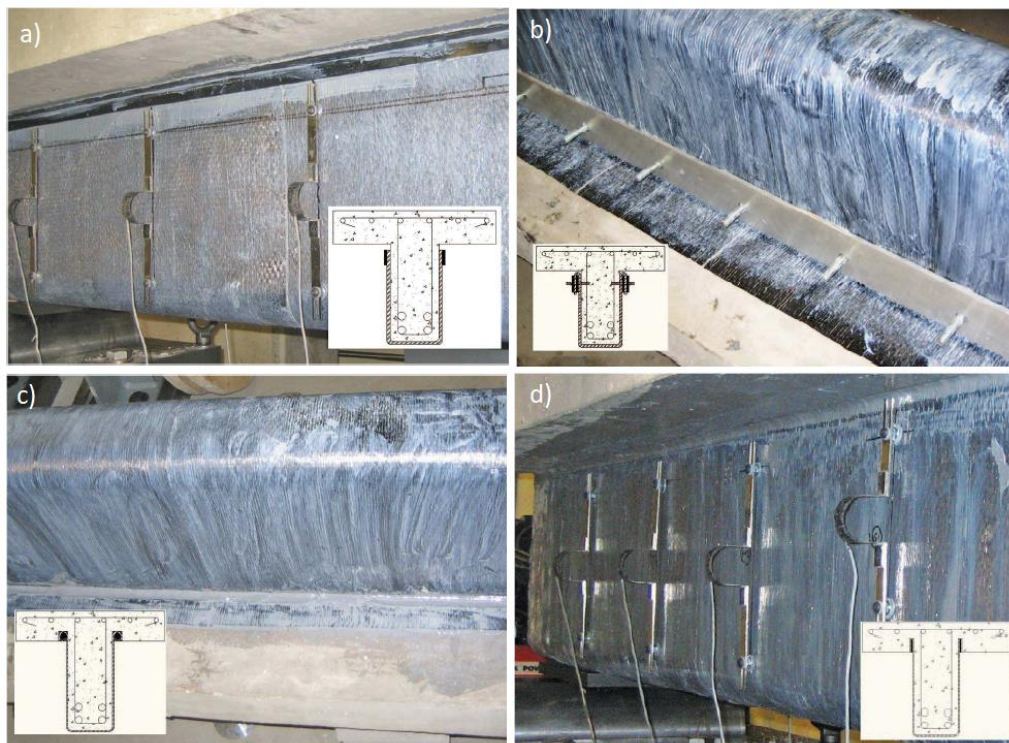
Rys. 2.38. Rodzaje zakotwień stosowane w belkach wg [48] a) SBFA, b) DAMA, c) ERBA, d) EFLA
