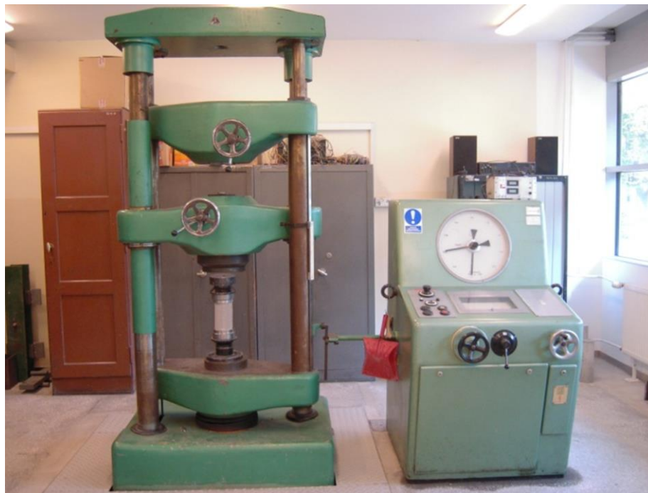
Rys. 4.13. Widok stanowiska do badania wytrzymałości na ściskanie próbki walcowej
