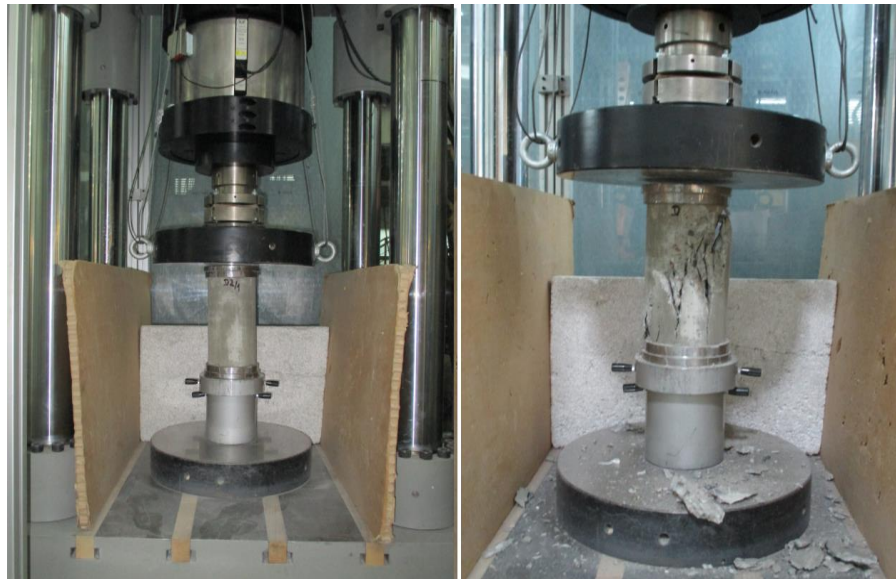
Rys. 4.60. Próbkę podczas oznaczania modułu sprężystości (po lewej) oraz po zniszczeniu (po prawej)
