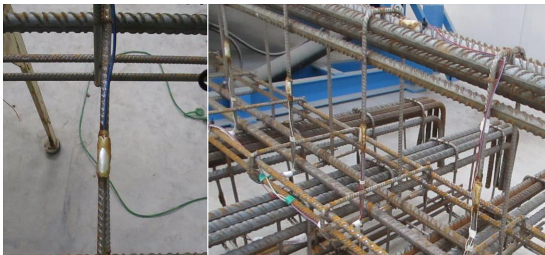
Rys. 4.55. Naklejanie tensometrów na prętach zbrojeniowych
