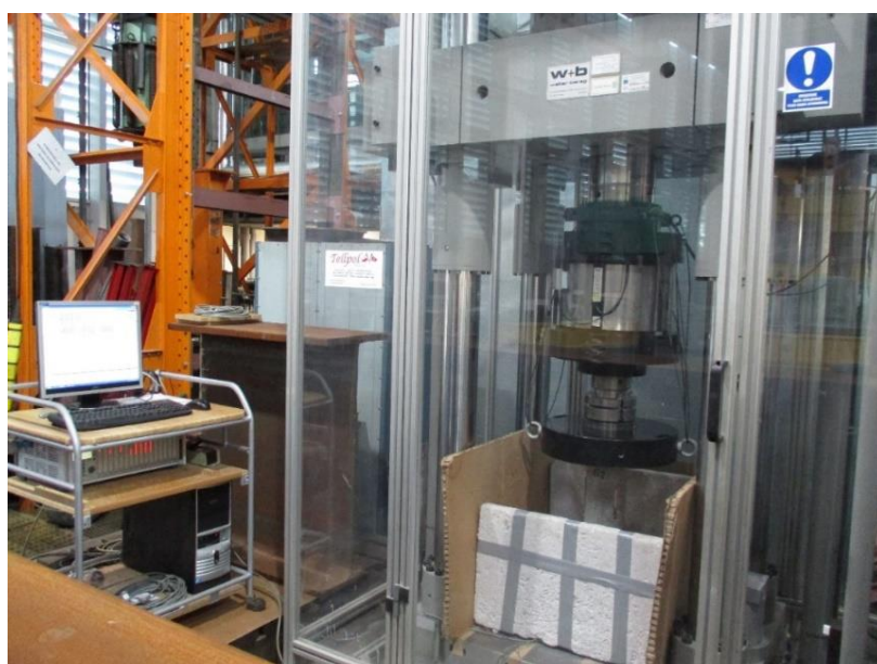
Rys. 4.58. Widok stanowiska do badania wytrzymałości na ściskanie próbki walcowej
