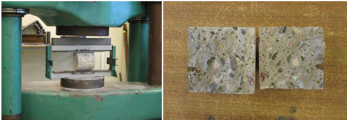
Rys. 4.59. Widok próbki w maszynie wytrzymałościowej w próbie rozłupywania oraz po zniszczeniu
