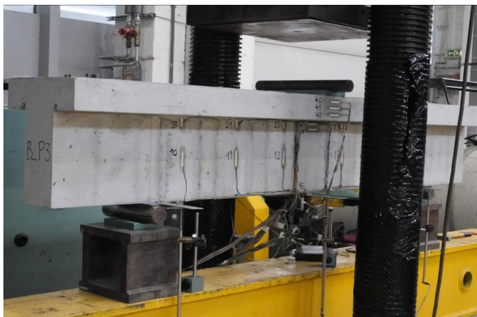
Rys. 4.26. Rozmieszczenie czujników indukcyjnych
