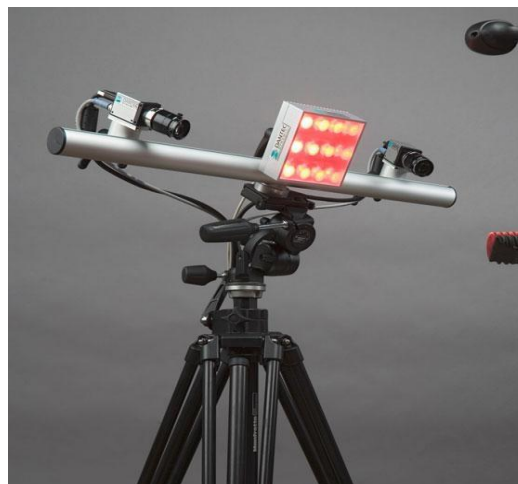
Rys. 4.63. Elementy systemu DIC firmy DANTEC, źródło: https://www.ita-polska.com.pl
