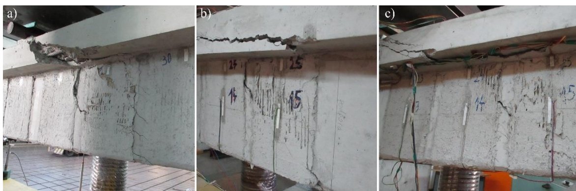
Rys. 4.76. Zniszczenie belek B_P200 w wyniku odspojenia strzemion PBO nad rysą ukośną
