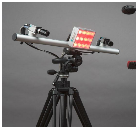
Rys. 4.63. Elementy systemu DIC firmy DANTEC, źródło: https://www.ita-polska.com.pl
