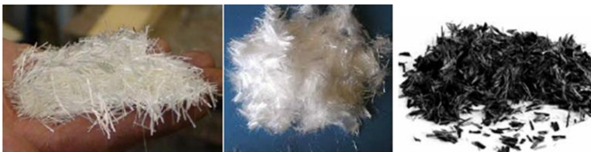
Rys. 2.6. Krótkie włókna szklane, propylenowe i węglowe [2]
