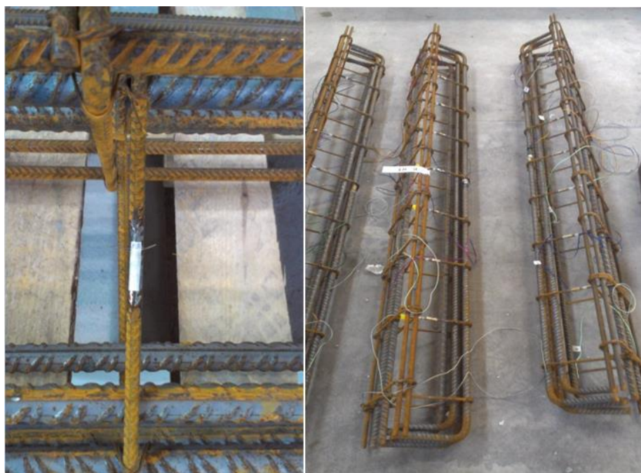
Rys. 4.5. Naklejanie tensometrów na prętach zbrojeniowych
