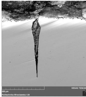
Rys. 9 Pęknięcie wypełnione tlenkami [H1]
