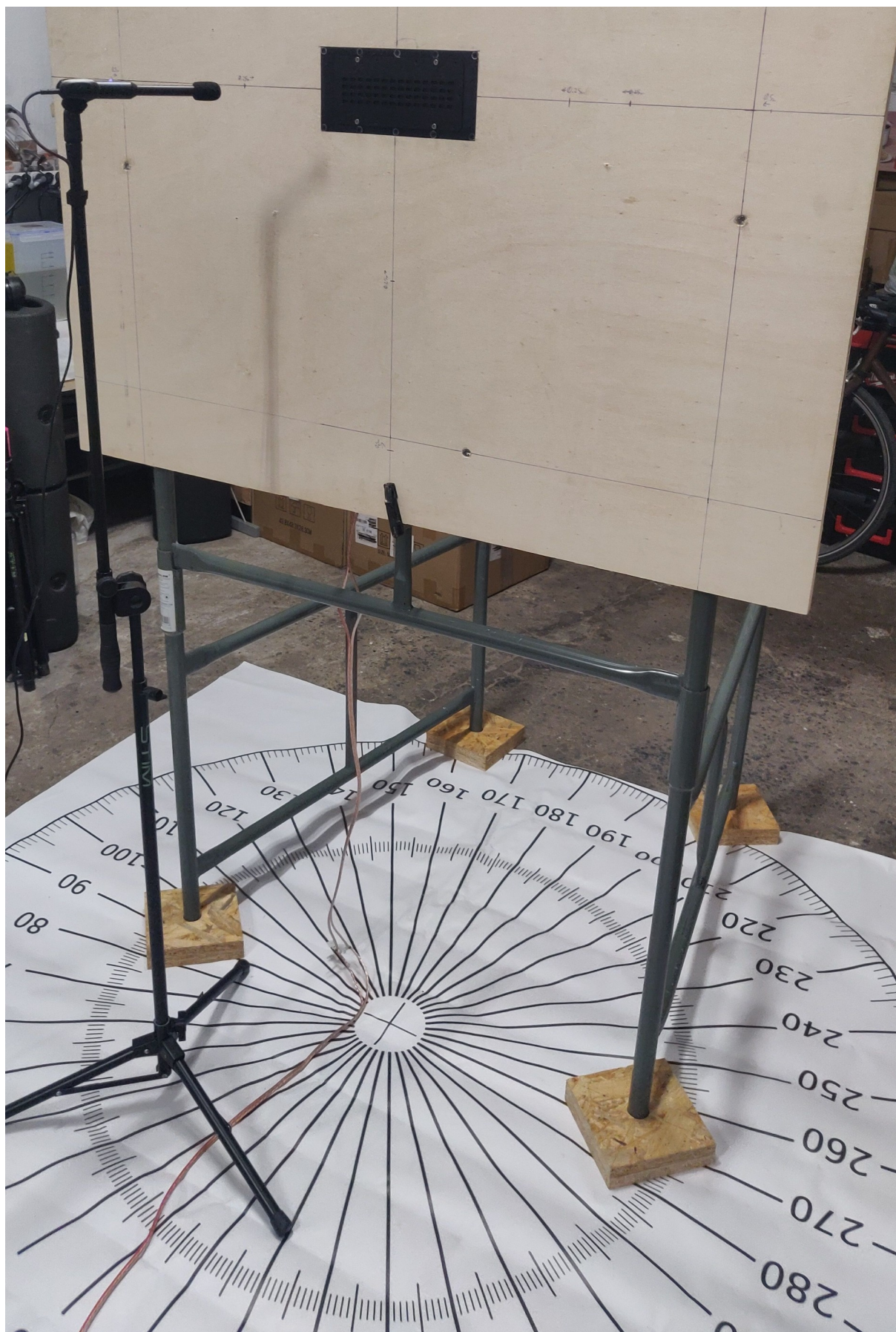
Rysunek 5.6 Przegroda pomiarowa z płaszczyzną ustalającą pozycję mikrofonu
