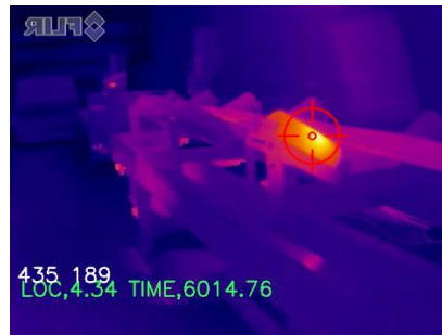
Rys. 8. Wynik działania algorytmu detekcji uszkodzonego krążnika przenośnika taśmowego
