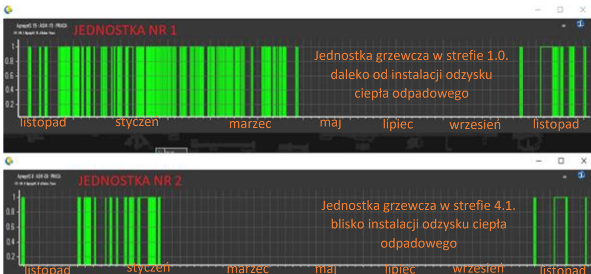
Rys. 31. Zestawienie czasu pracy dwóch gazowych aparatów grzewczych. Jednostka nr 1 znacznie oddalona od pomieszczenia sprężarkowni na hali produkcyjnej, jednostka nr 2 zlokalizowana blisko hali pomieszczenia sprężarkowni.
