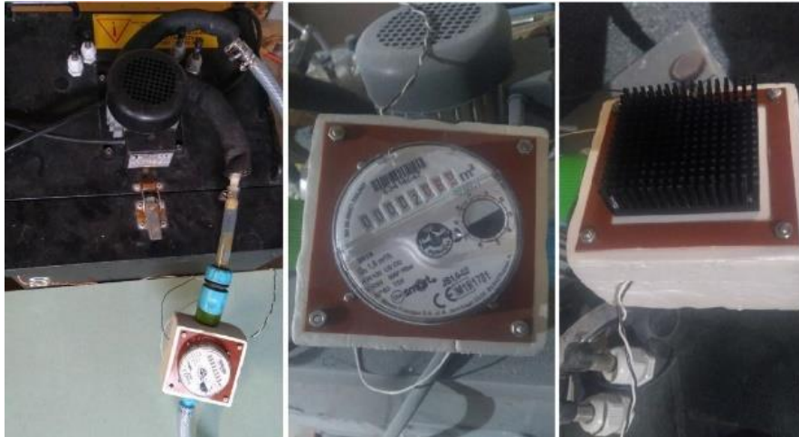
Rys. 62. Laboratoryjny układ harvestera energii cieplnej, zainstalowany na wodomierzu.
