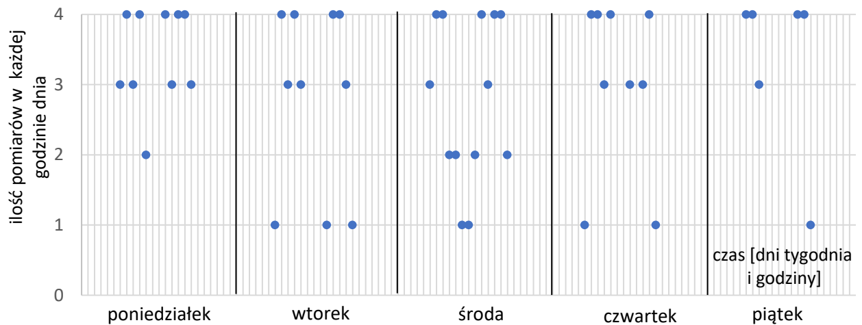
Rys. 96. Rozkład odebranych transmisji LoRa pomiędzy bezprzewodową platformą czujnikową, a serwerem LoRa podczas badań realizowanych w warunkach przemysłowych z harvestingowym zasilaniem platformy czujnikowej.
