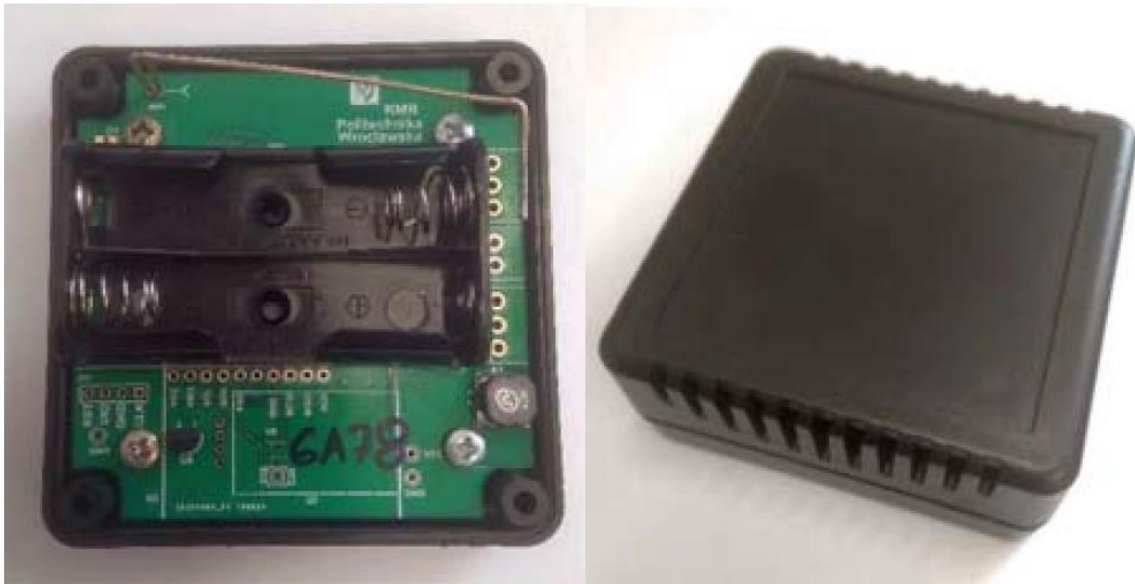
Rys. 36. Widok platformy czujnikowej w konfiguracji z czujnikiem temperatury DS18B20 zabudowanej w obudowie KRADEX Z123.
