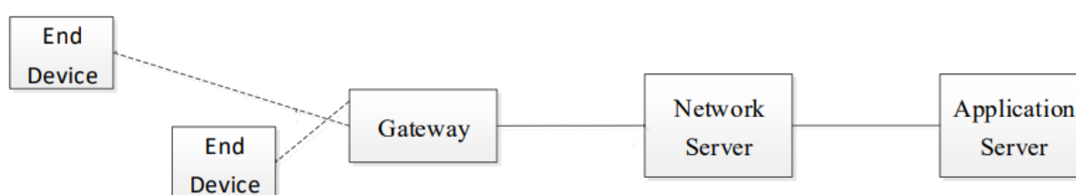
Rys. 40. Schemat architektury sieci LoRaWAN [78].
