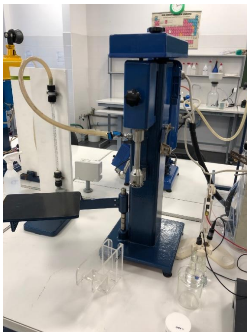
Rysunek 7.7. Laboratoryjna maszynka flotacyjna typu Mechanobr.
