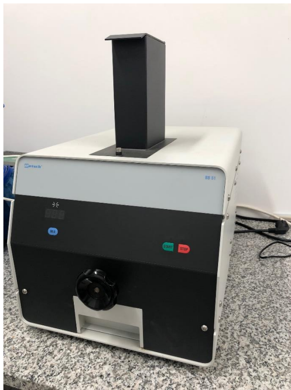
Rysunek 7.4. Kruszarka szczękowa wykorzystana do badań
