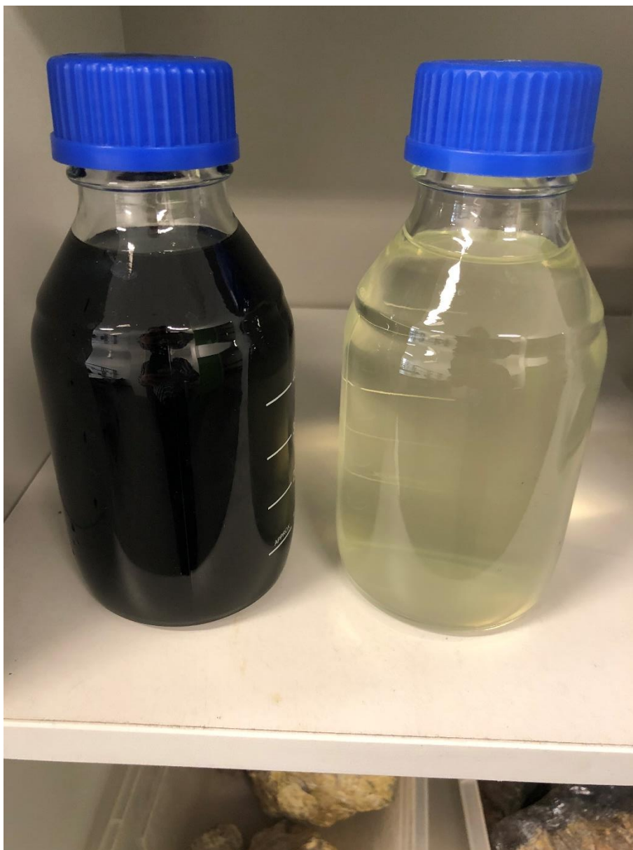
Rysunek 8.69. Roztwory cieczy ciężkiej po przeprowadzeniu separacji rudy chondrytowej
