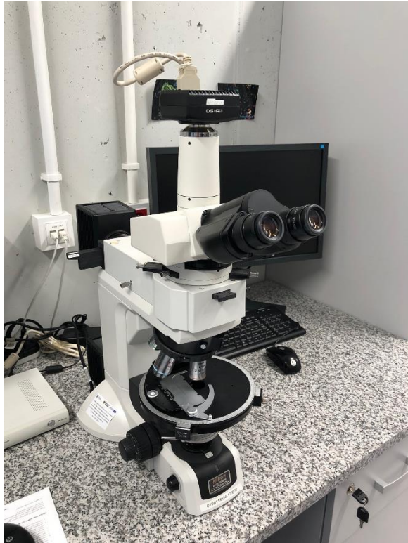
Rysunek 7.1. Mikroskop petrograficzny użyty w badaniach
