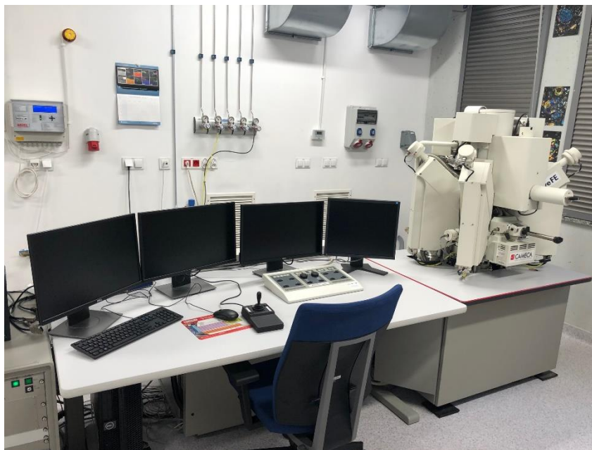
Rysunek 7.3. Mikrosonda elektronowa wykorzystana do badań
