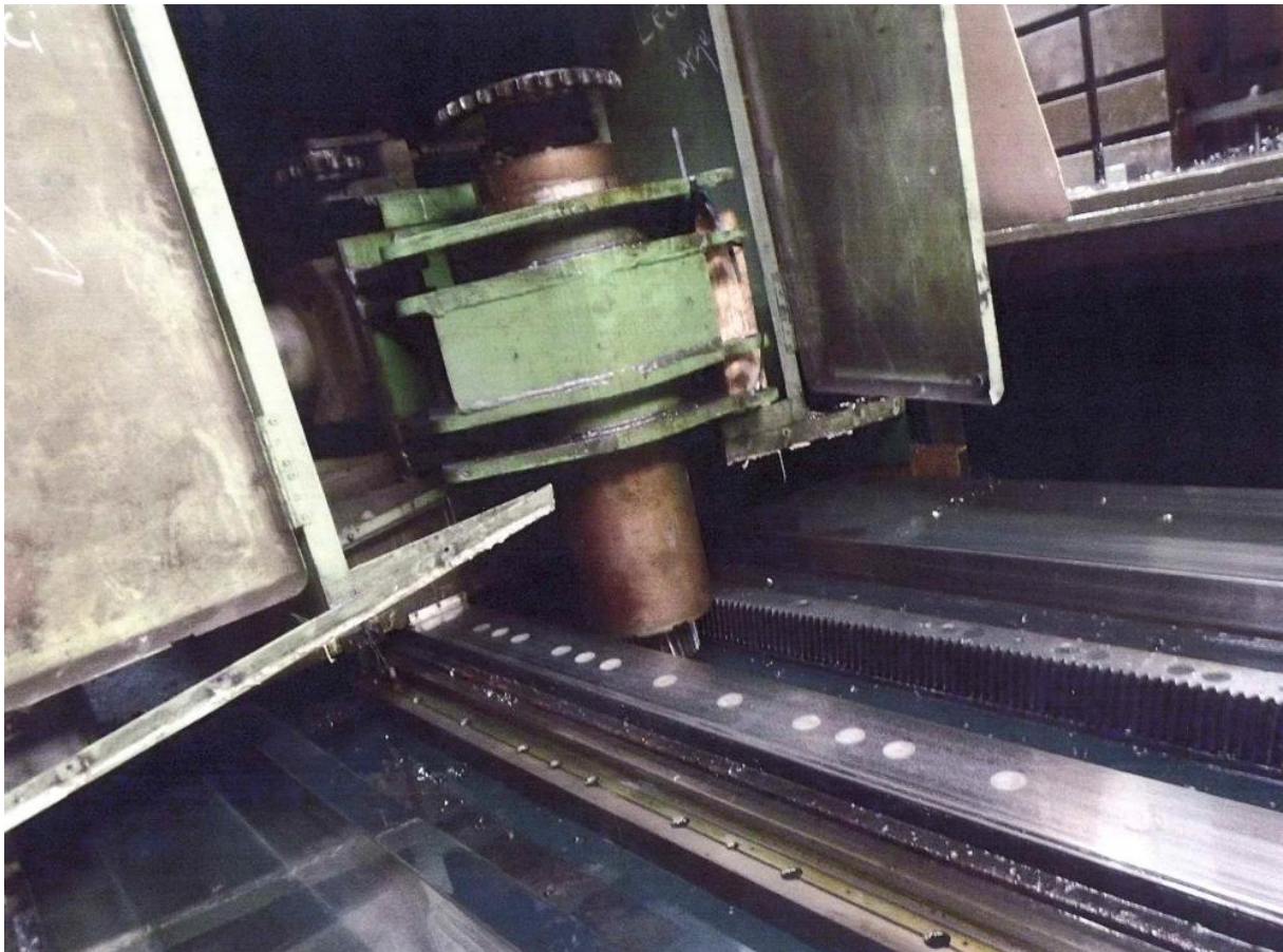
Rysunek 13. Drugi zębnik zainstalowany w obrabiarce SKODA WD200B.
