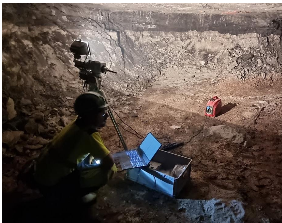
Rys. 4.6 Skaner opracowany w trakcie realizacji doktoratu wdrożeniowego w trakcie gromadzenia danych hiperspektralnych w obrębie wyrobiska miedzionośnego. Materiał Autora
