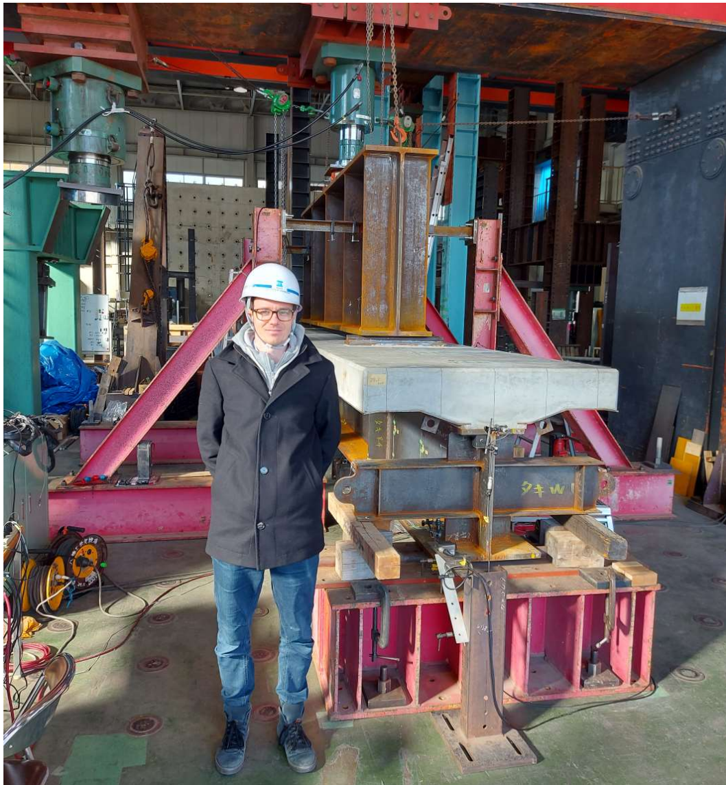
Rys. 51 Wnioskodawca podczas badań niszczących belkę zespoloną z zespoleniem za pomocą listwy z wytłaczanym uźbrowaniem (opis w tekście)
