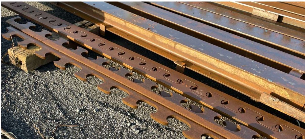
Rys. 23 Grzebienie z łącznikami MCL o gr. 30 mm przed przyspawaniem do średników (gr. 12 mm) stalowych teowników
