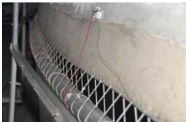
121. Dolny system obciążenia i korekty obrazu Panoramy Racławickiej we Wrocławiu, 2016 rok. Fot. Ryszard Wójtowicz
