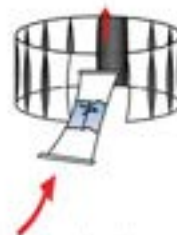
Sukcesywne zawieszanie zamocowanych w „karniszu” nowo-utworzonych brytów 1–14
