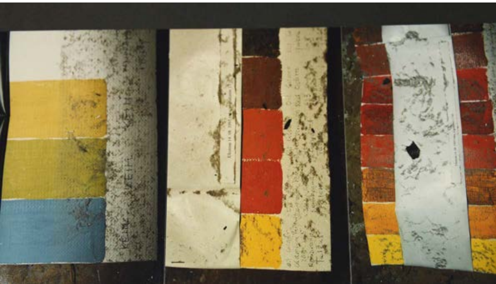
71. Próbniki farb badanych podczas pracy w panoramach, rozmieszczone w ukrytych miejscach przedpola, 1995 rok. Fot. Ryszard Wójtowicz
