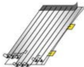
Przytwierdzenie do odwrocia brytu 8 pasów tkaniny dublażowej – szklanej wcześniej powleczonej spoiwem dublażowym (Lascaux Acrykleber 498 HV lub Beva 371) na 2 cm zakładkę; dublowanie górnego odcinka na długości 3m oraz zdublowanie tkaniny wzmacniającej szer. 0,8m przy górnej krawędzi brytu
