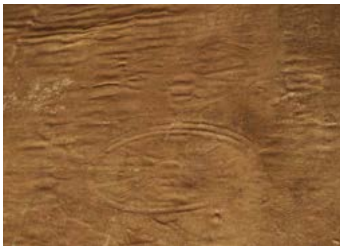
254. Detal odwrocia sekcji obrazu cykloramy Bitwa pod Gettysburgiem po usunięciu masy woskowo-żywicznej, poważny stopień osłabienia podobrazia spowodował liczne drobne deformacje i odciski modelunku warstwy malarskiej na odwrociu obrazu, Gettysburg 2006 rok. Fot. Ryszard Wójtowicz
