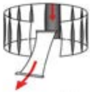
Opuszczanie poszczególnych części – brytów na platformę roboczą
