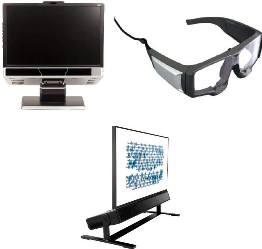
Rycina 12. Tobii Pro Spectrum - przykład okulografu stacjonarnego https://www.tobii.com/products/eye-trackers/screen-based/tobii-pro-spectrum
