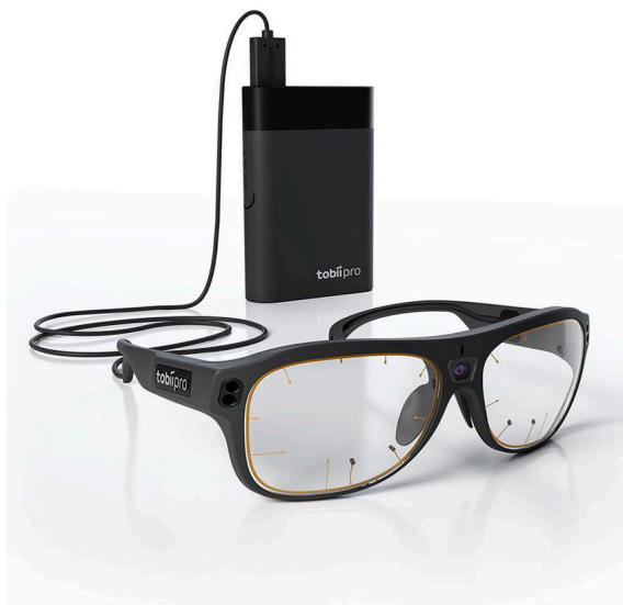
Rycina 13. Tobii Glasses 3 - przykład okulografu mobilnego https://www.brainproducts.com/solutions/tobii-pro-wearable/#
