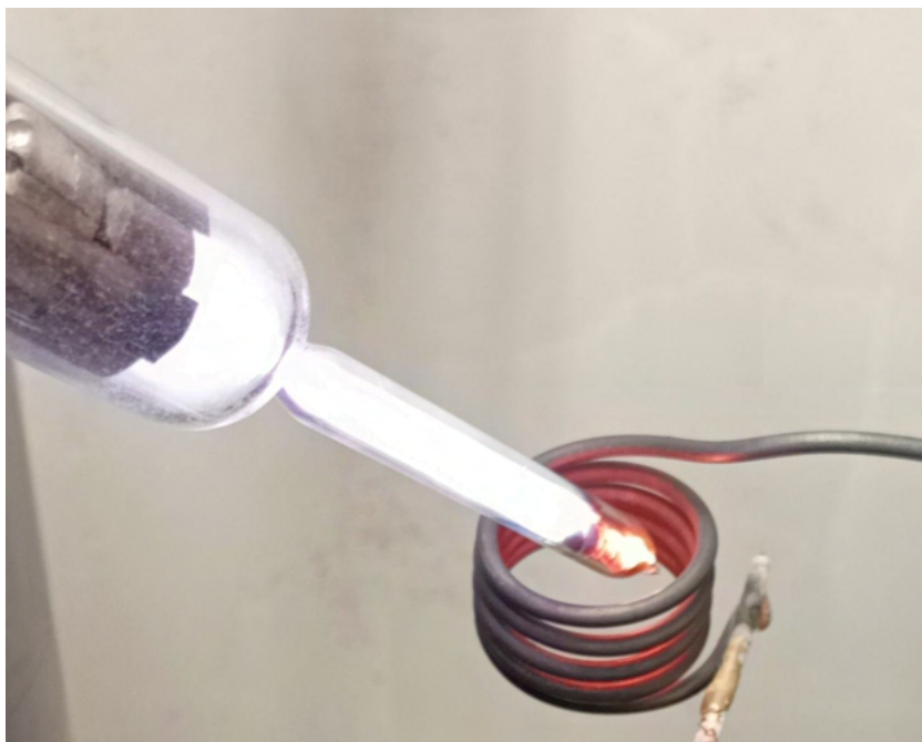
Rysunek 5.7. Rozgrzewanie getera w piecu indukcyjnym.
