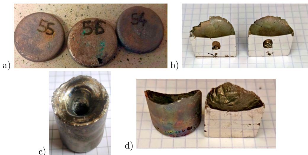
Rysunek 5.3. a) – Próbki po pierwszym przetopieniu, b) – przekrój próbki z jamą skurczową w środku, c) – jama skurczowa na górze próbki, d) – przekrój próbki bez jamy skurczowej.
