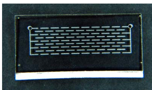
Rysunek 19. Kolektor prądu z mikrokanalami rozprowadzającymi elektrolit oraz ścieżką elektroprzewodzącą.
