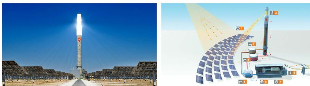
(b): (1) pole heliostatów, (2) zbiornik soli chłodnej, (3) wieża z centralnym odbiornikiem promieniowania, (4) zbiornik soli gorącej, (5) wytwornica pary, (6) turbina parowa, (7) generator elektroenergetyczny, (8) transformator sieciowy;
