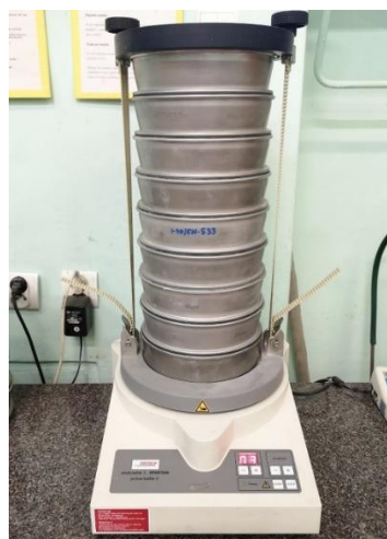
Rys. 25. Stanowisko badawcze do analizy sitowej dodatków mineralnych z zestawem sit.
