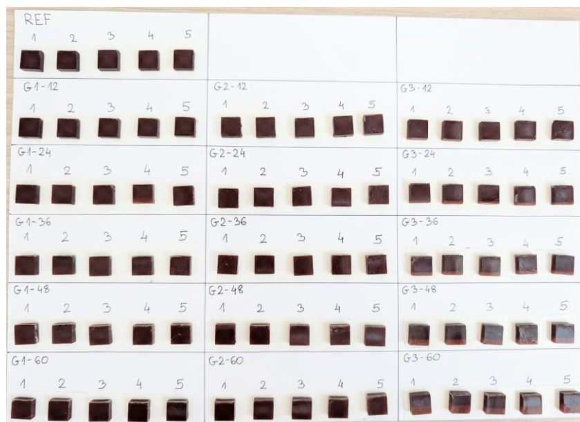
Rys. 37. Próbkę prostopadłościenną utwardzonych żywic epoksydowych przygotowane do badań gęstości i wytrzymałości na ściskanie.
