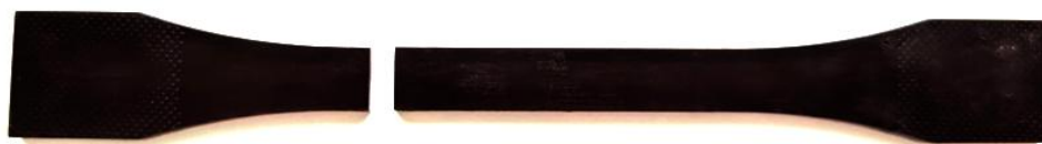
Rys. 83. Próbką po badaniu rozciągania z inicjacją pęknięcia w górnej strefie przejściowej, w zgodzie z lokalizacją uszkodzenia przewidzianą w modelu MES.
