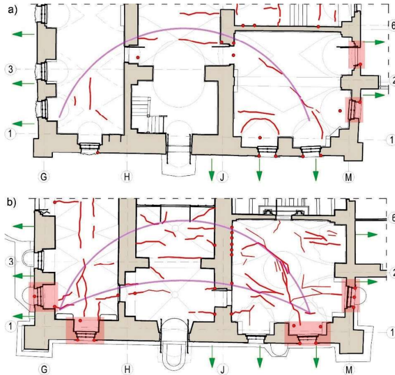
Rys. 29 Morfologia zarysowania nadproży, ścian i sklepień w pałacu w Łłowej w części renesansowej: a) rzut pierwszego piętra, b) rzut parteru [1]
