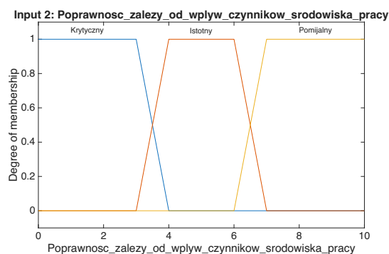
(c) MF wyjściowej wpływu czynników środowiska pracy na urządzenie
