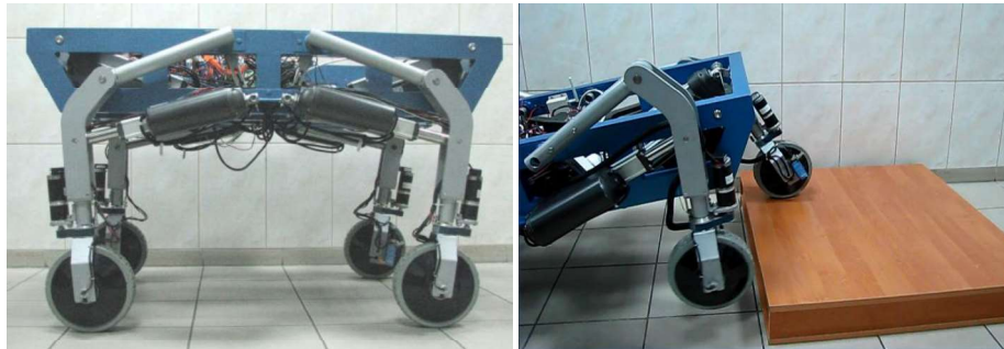
Rys. 4. Prototyp robota z funkcją poziomowania i pokonywania przeszkód
