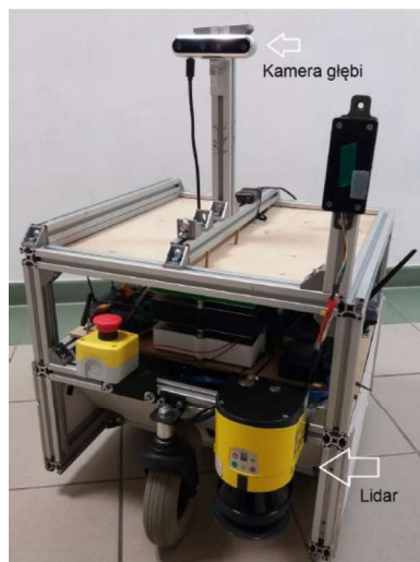
Rys. 7. Prototyp autonomicznego robota mobilnego
