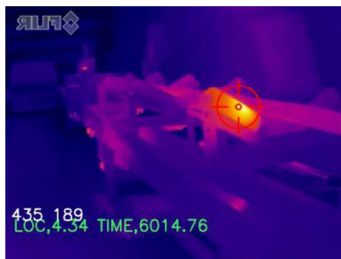
Rys. 8. Wynik działania algorytmu detekcji uszkodzonego krążnika przenośnika taśmowego
