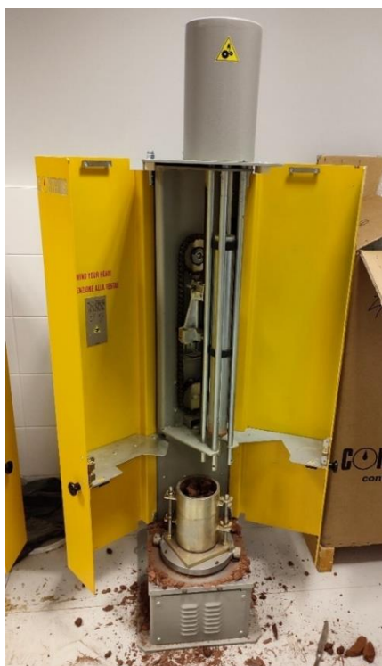
Rysunek 3.9. Automatyczny ubijak Proctora przed badaniem zagęszczalności.
