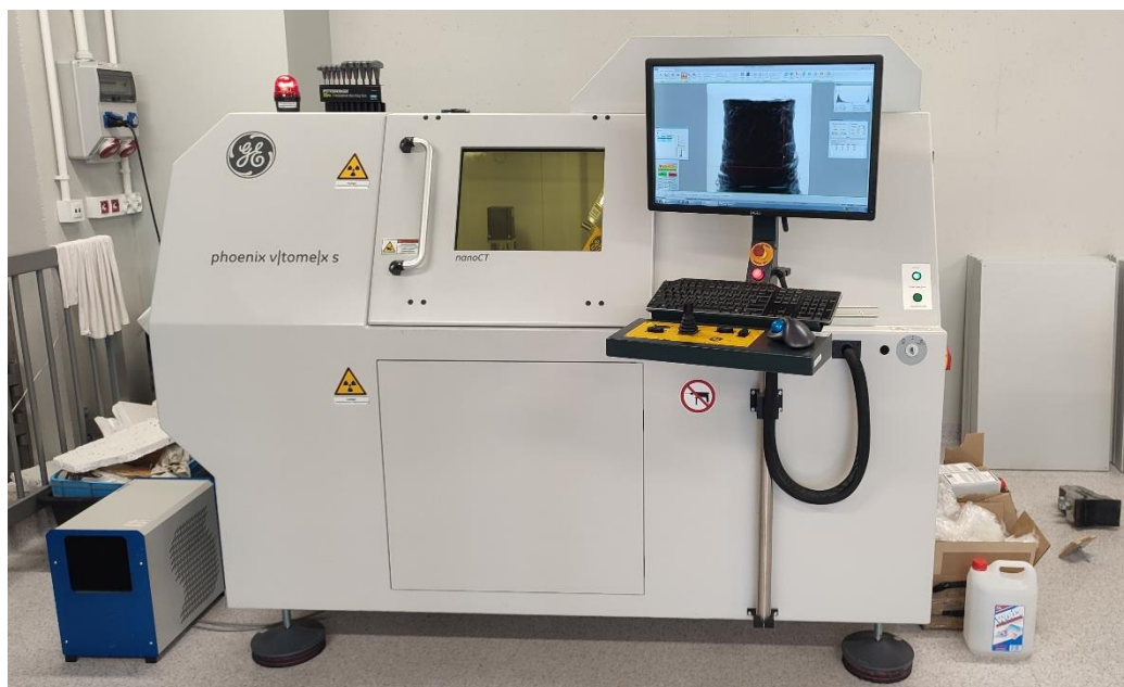
Rysunek 3.29. Tomograf w trakcie badania: a) próbka gruntu umieszczona w komorze tomografu, b) tomograf w komputerowy podczas wykonywania skanów.
