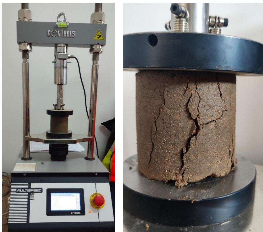
Rysunek 3.23. Badania wytrzymałość na ściskanie w stanie jednoosiowego naprężenia: a) maszyna wytrzymałościowa, b) próbka po badaniu z widocznymi pionowymi pęknięciami oraz złuszczeniami materiału gruntowego.
