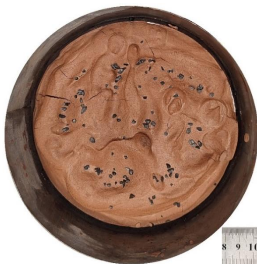
Rysunek 3.27. Fotografie powierzchni próbek gruntu drugiej serii badań, które zostały pokryte markerami wizualnymi: a) ił o wilgotności w = 106\% , b) ił zbrojony włókami juty o wilgotności w = 108\% , c) ił zbrojony włókami polipropylenowymi o wilgotności w = 111\% , d) pył z iłem o wilgotności w = 72\% , e) pył o wilgotności w = 45\% , f) pył zbrojony włókami juty o wilgotności w = 44\% , g) pył zbrojony włókami polipropylenowymi o wilgotności w = 45\% , h) pył o wilgotności w = 46\% z dodatkiem cementu.
