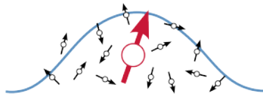
Rysunek 2.6: Spin elektronu (czerwona strzałka) oddziałujący ze spinami jądrowymi (czarne strzałki) w kropce kwantowej.
