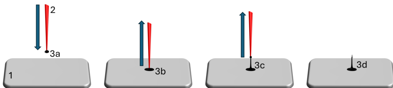
Rysunek 6.6 – Schemat formowania ostrza kompozytu CNT-PVP metodą termiczno-mechanicznego ciągnięcia.
