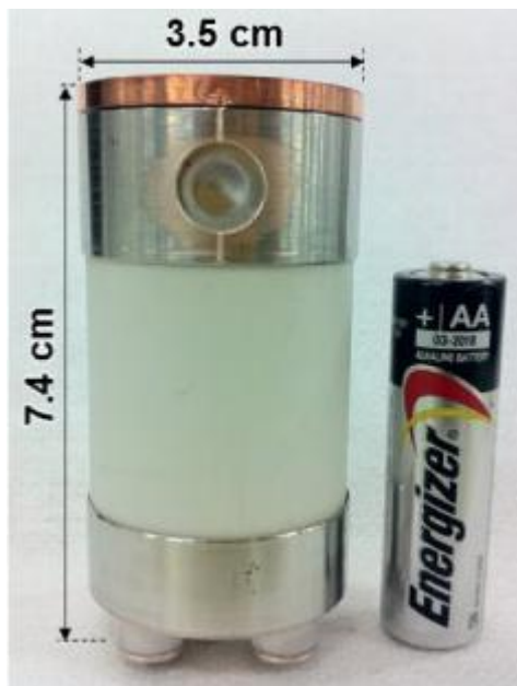
Rysunek 4.3. Konstrukcja miniaturowej lampy rentgenowskiej z emiterem elektronów CNT [119].
