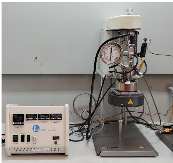
Rys. 23. Reaktor hydrotermalny Parr z mieszadłem (po prawej) i kontroler (po lewej).
