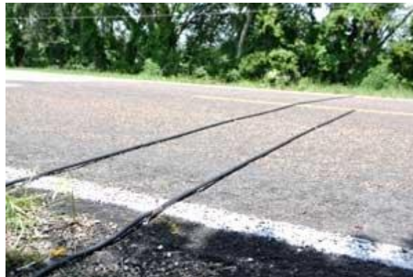
Rys. 2.3 System identyfikacji pojazdu w postaci pary czujników pneumatycznych zamontowanych w nawierzchni drogowej [20]
