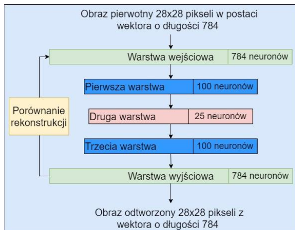
Rys. A.2 Autodekoder stosowy
