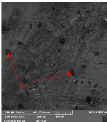
Rys. 14.13 Obrazy śladu wytarcia powstałego podczas testu kulka na tarczy wykonane dla materiału A w powiększeniu: I.- 500x, II.- 1000x.
