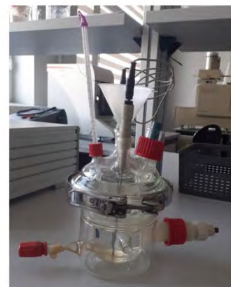
Rys. 11.6 Zdjęcie stanowiska do badań elektrochemicznych: a) sterownik komputerowy z oprogramowaniem oraz potencjostat, b) naczynie pomiarowe
