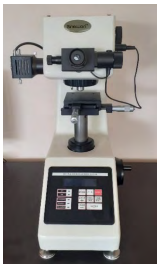
Rys. 10.2 Twardościomierz Vickersa Sinowon HV-1000
