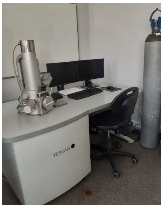
Rys. 8.2 Skaningowy mikroskop elektronowy Tescan Vega3
