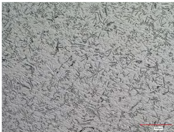
Rys. 14.4 Warstwa napawana, obszar powyżej linii wtopienia - materiał C, powiększenie 200x
