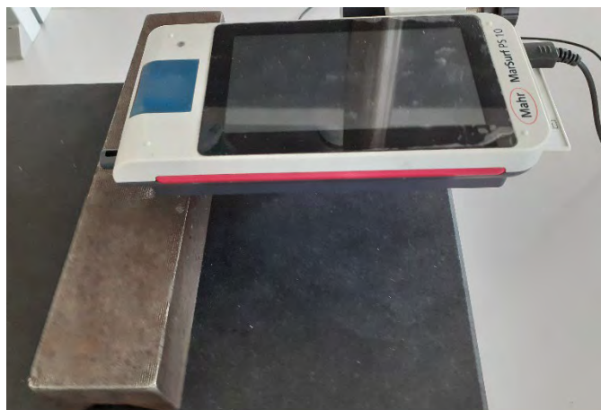
Rys. 11.7 Profilometr stykowy MarSurf PS 10
