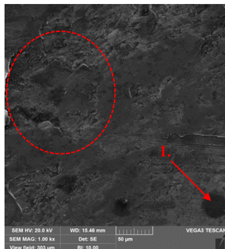
Rys. 14.13 Obrazy śladu wytarcia powstałego podczas testu kulka na tarczy wykonane dla materiału A w powiększeniu: I.- 500x, II.- 1000x.
