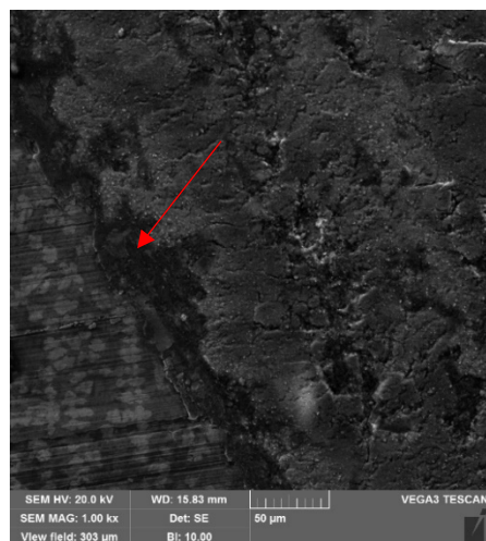
Rys. 14.14 Obrazy śladu wytarcia powstałego podczas testu kulka na tarczy wykonane dla materiału B w powiększeniu: I.- 500x, II.- 1000x
