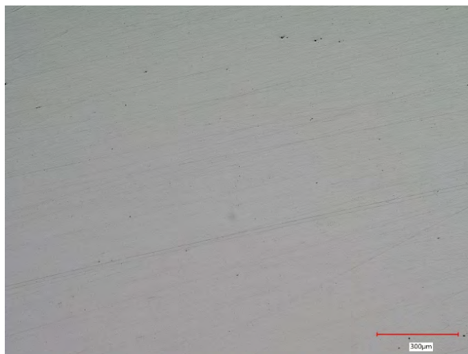
Rys. 14.5 Warstwa napawana, obszar powyżej linii wtopienia - materiał D, powiększenie 200x
