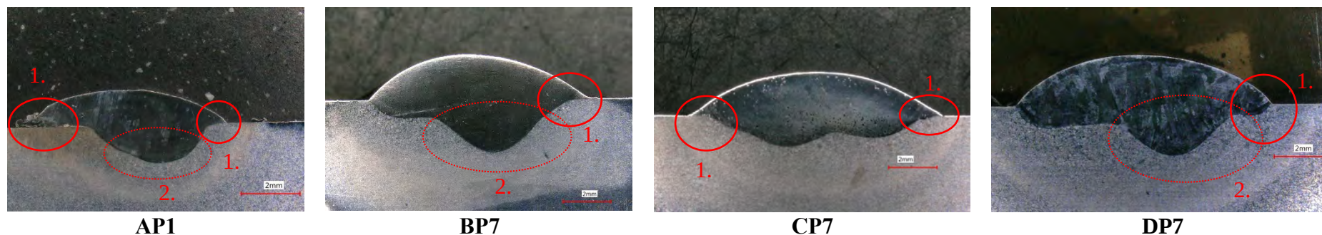
Rys. 13.2 Widok napoiny uzyskanych przy nieodpowiednio dobranych parametrach procesu z wyraźnymi defektami spawalniczymi: 1.- przyklejenie, 2.- znaczący stopień wymieszania napoiny z materiałem podstawowym
