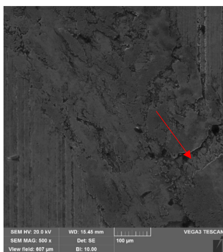
Rys. 14.15 Obrazy śladu wytarcia powstałego podczas testu kulka na tarczy wykonane dla materiału C w powiększeniu: I.- 500x, II.- 1000x
