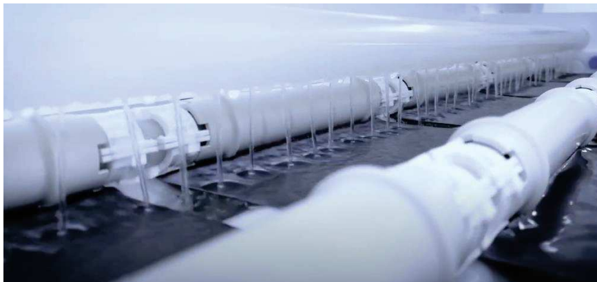
Rys. 15. Transport płytek krzemowych na rolkach z dodatkowym natryskiem i dociskiem.
