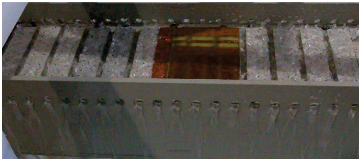
Rys. 23. Przenośnik fluidalny eliminujący kontakt transportowanego elementu z częściami przenośnika podczas testów laboratoryjnych.
