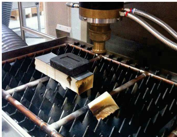
Rys. 7. Rozwiązanie techniczne umożliwiające wytworzenie niepalnej atmosfery w strefie przecinania laserowego - implementacja praktyczna rozwiązania na stanowisku badawczym.
