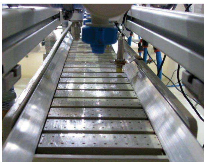
Rys. 24. Przenośnik fluidalny eliminujący kontakt transportowanego elementu z częściami przenośnika – widok na jeden z wariantów płyty transportowej.
