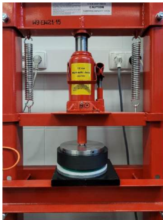
Rysunek 5.3. a) Wydruk tarczy tylnej na drukarce 3D Prusie MK3, b) Sklejanie z wykorzystaniem prasy hydraulicznej
