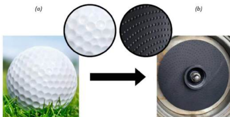
Rysunek 2.18. Idea zastosowania wgłębień i model wirnika ze strukturą [48]
