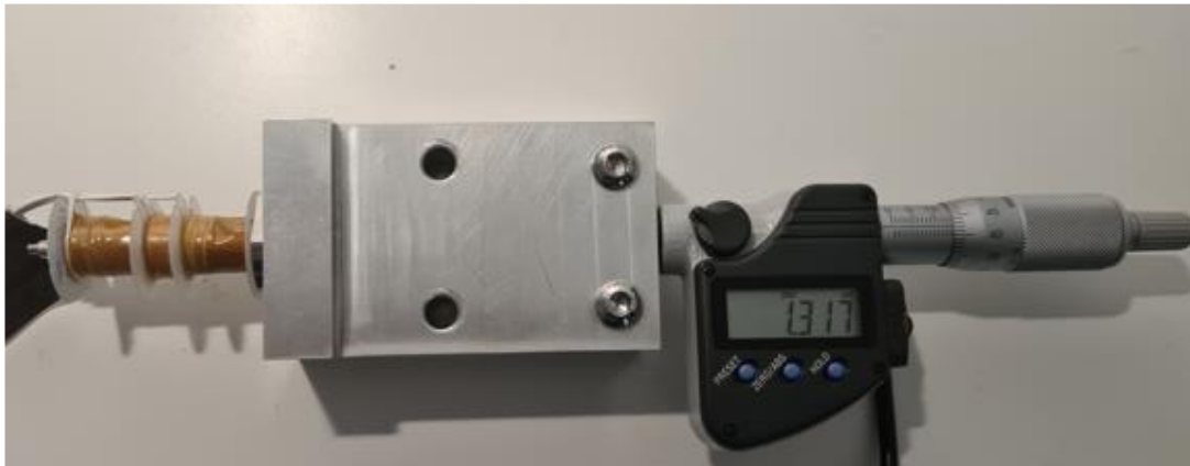
Rys. 4.54. Układ pomiarowy zbudowany w celu weryfikacji modelu teoretycznego transformatora różnicowego, ze zdemontowanym ekranem magnetycznym na zewnątrz uzwojenia
