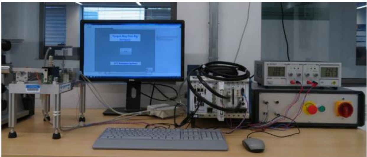
Rys. 4.48. Stanowisko do badania charakterystyki statycznej silników momentowych wykorzystywanych w serwozaworach
