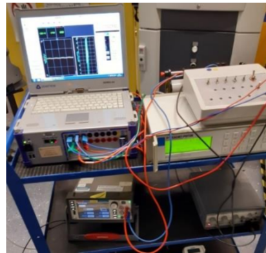
Rys. 4.22. Stanowisko do badań quasistatycznej charakterystyki magnesowania B(H) w temperaturach
