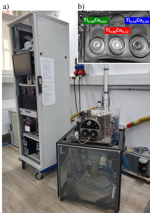
Rys. 4.4. Zdjęcie: a) stanowiska do rozpylania magnetronowego wykorzystanego do wytworzenia cienkich warstw w procesie z ciągłym przepływem gazów (MS), b) spiekanych targetów Ti-Co o różnej zawartości Co zamontowanych w magnetronach
