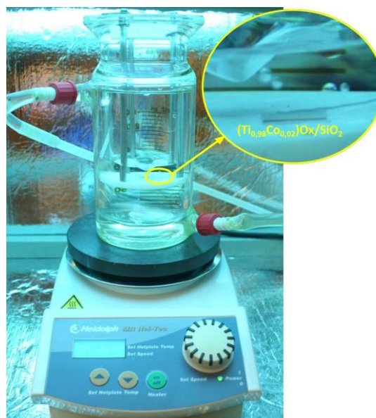
Rys. 5.21. Widok reaktora kwarcowego z roztworem fenolu w którym zaznaczono badaną próbkę w postaci (Ti 0,98 Co 0,02 )Ox/SiO 2 podczas reakcji fotokatalizy
