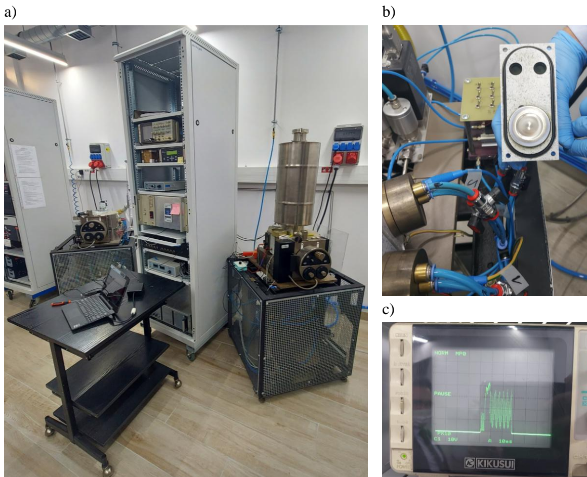
Rys. 4.9. Zdjęcia: a) stanowiska do wytwarzania cienkich warstw (Ti,Co)O x metodą rozpylania magnetronowego w procesie z impulsowym dozowaniem gazów (GIMS), b) widok targetu Ti-Co zamontowanego w magnetronie oraz c) przebieg czasowy zarejestrowany na oscyloskopie, który pokazuje czas trwania impulsu podczas którego zapalona była plazma nad targetem
