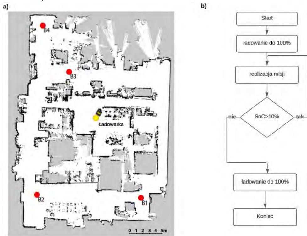
Rys. 32 Mapa obszaru z zaznaczonymi punktami pośrednimi (B1-B4) i stacją ładującą (a) oraz schemat algorytmu automatycznej realizacji pomiarów (b).
