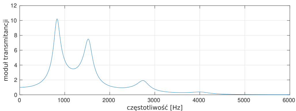
Rys. 4.3: Przykładowy moduł funkcji transmitancji modelowego kanału głosowego dla samogłoski a .
