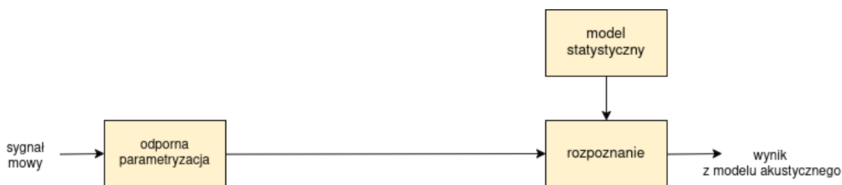
Rys. 2.4: Fragment podsystemu akustycznego z odporną parametryzacją w systemie ARM.
