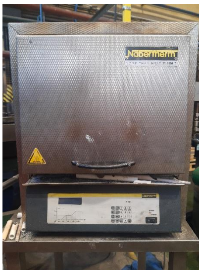
Rys. 41. Piec laboratoryjny Nabertherm z programowalnym schematem nagrzewania
