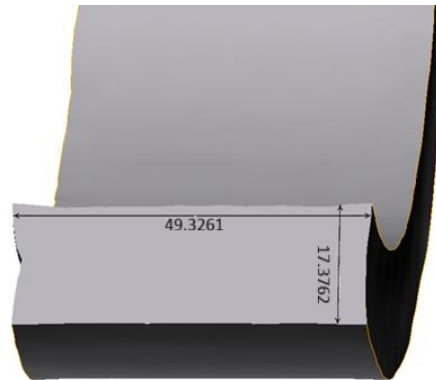
Rys. 38. Przekrój pierścienia otrzymanego dla prędkości przemieszczenia trzpienia 0,7 mm/1 obrót pierścienia.
