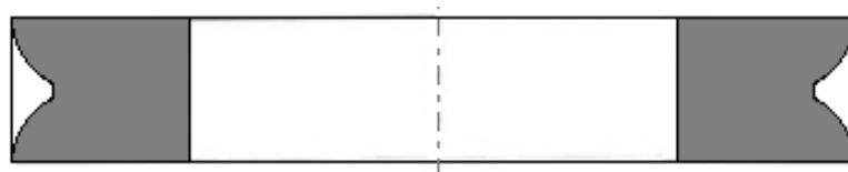
Rys. 3. Wgłębienie „cavity” na powierzchni walcowanego pierścienia [11]
