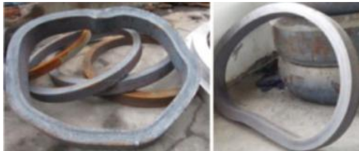
Rys. 10. Pierścienie odpadowe o zniekształconym kształcie w rzeczywistej produkcji [37]
