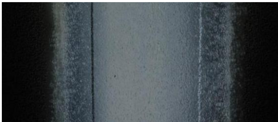
Rysunek 15. Fragment światłowodu HCF z usuniętym z zastosowaniem wiązki IR pokryciem polimerowym. Źródło: materiały własne.
