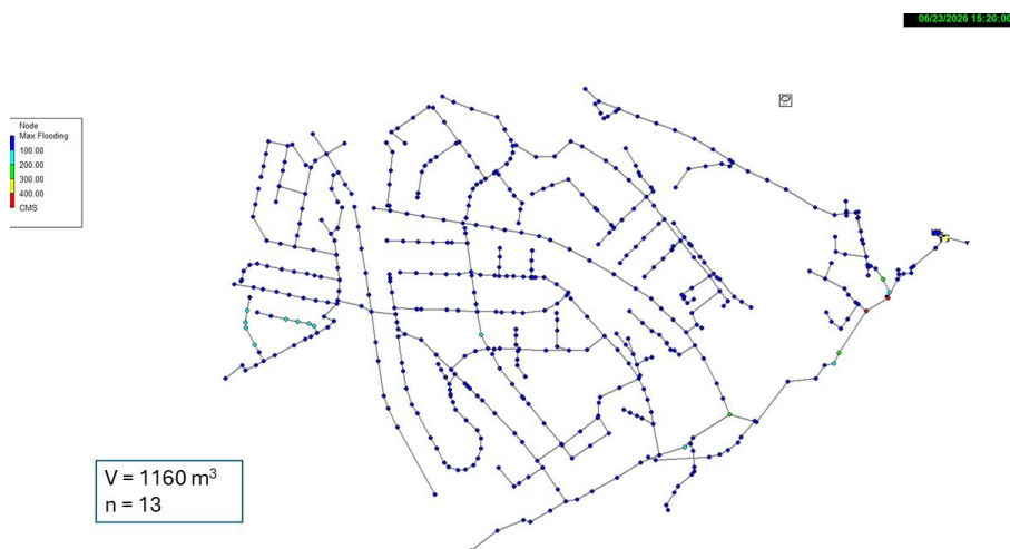
Rysunek 16. Lokalizacja węzłów z wylaniami z sieci kanalizacyjnej dla wariantu bazowego (opad C = 5 lat)
